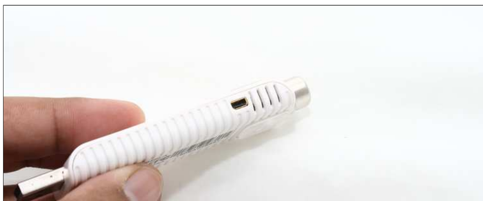
ส่วนด้านข้างเป็นช่องเสียบสายสัญญาณ AV/S-Video
